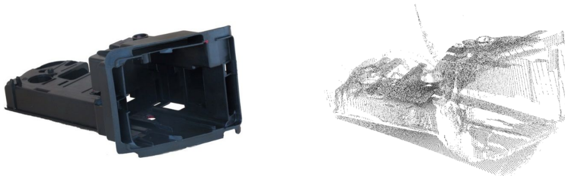
Obr. 18.2 – Příklad plastového dílu a naměřených 3D bodů popisujících objekt. Viditelné jsou artefakty vzniklé při detekci stopy laserového paprsku, které se snažíme eliminovat.
