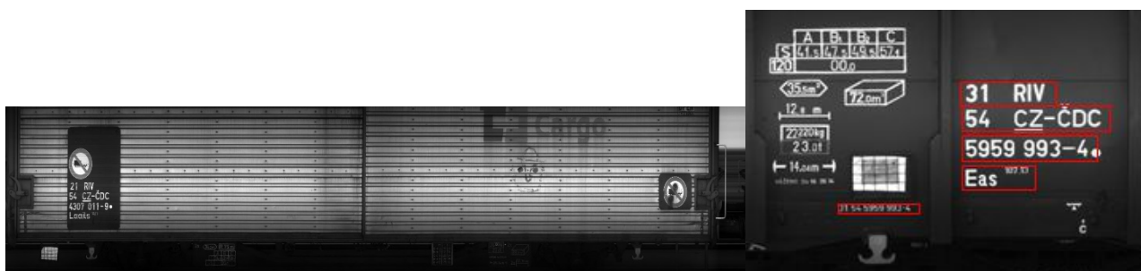
Obr. 19.1 – Vůz nákladní vlakové soupravy s UIC označením a detail rozpoznávání polohy a typu identifikačních kódů.
