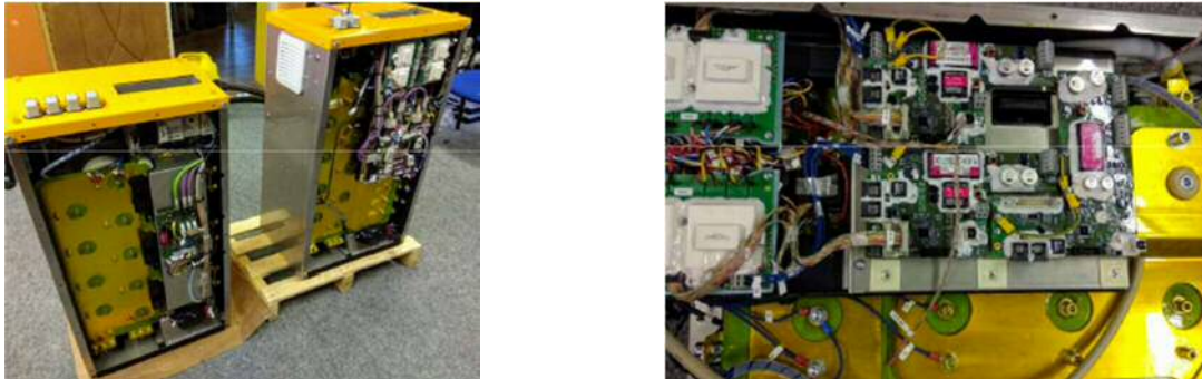
OBRÁZEK 2: NAVRŽENÝ TRAKČNÍ MĚNIČ (LEVÝ OBRÁZEK) A POHLED NA ŘÍDÍCÍ ELEKTRONIKU (PRAVÝ OBRÁZEK)
