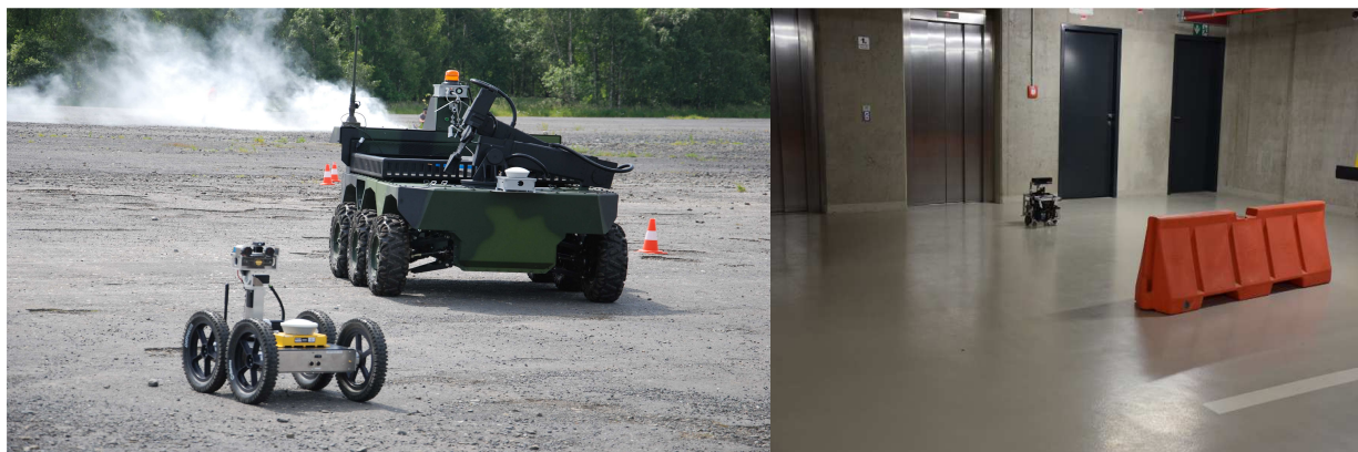
Obr WP6.1. Vlevo: Roboty TAROS a ORPHEUS při experimentu vizuální navigace, vpravo: robot ER1 s funkčním vzorkem navigačního modulu prohledávající neznámé prostředí.
