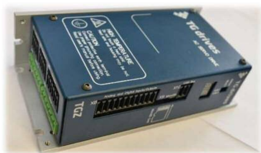
Obrázek 3: Servozesilovač TGZ-D-48-13/40 - hotový výrobek (vlevo), deska plošných spojů (vpravo).
