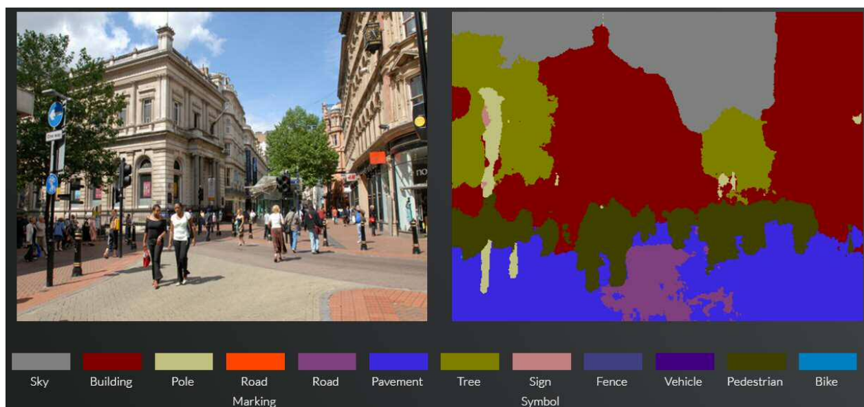
Obr. 2 Ukázka sémantické segmentace obrazu pomocí hluboké konvoluční sítě SegNet [Kendall2015].
