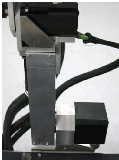
Obrázek 1. Mechanika kamerového manipulátoru se třemi stupni volnosti
