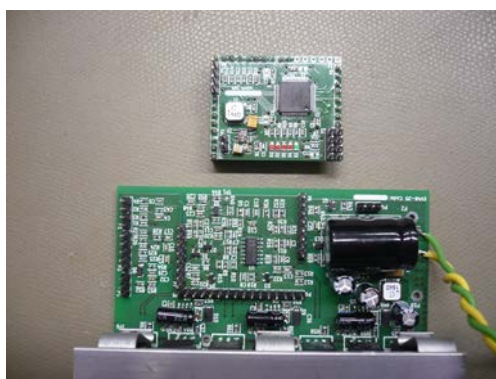
Obr. WP3.1. Použitý třífázový měnič navržený a modernizovaný v předchozích letech projektu.
