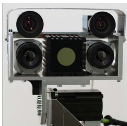
Obrázek WP4.1. 3D model robotu Orpheus (vlevo), fotografie multispektrální senzorické hlavičky umístěné na 3DOF manipulátoru (vpravo).
