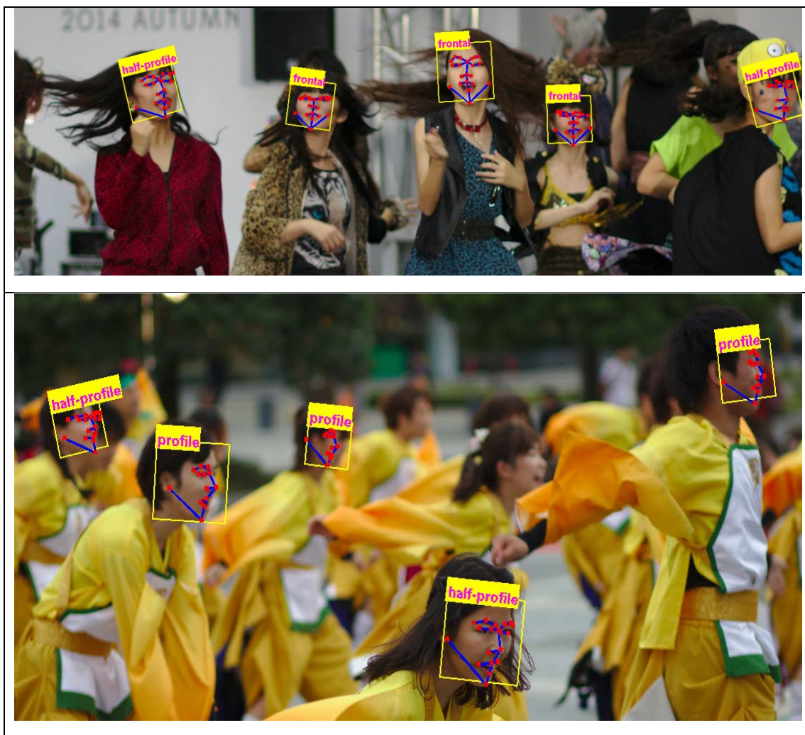
Obr. WP7.3. Příklady výstupu detektorů tváří. Žluté čtverce označují tváře detekované obecným detektorem tváří. Červené body ukazují umístění významných bodů, modré čáry reprezentují strukturu grafu využíteho pro detekci směru pohledu. Výsledek detekce směru pohledu je zapsán fialově nad detekovanou tváří.
