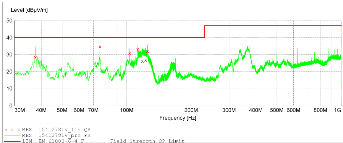
Obr.2: Frekvenční charakteristika servozesilovače TGZ-48 při vertikální polarizaci antény.
